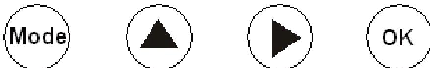
**【Mode】:** 菜单键。按【Mode】出现密码界面，输入密码进入菜单，在设置时按【Mode】取消设置，设置完毕后，按【Mode】键退出菜单。
